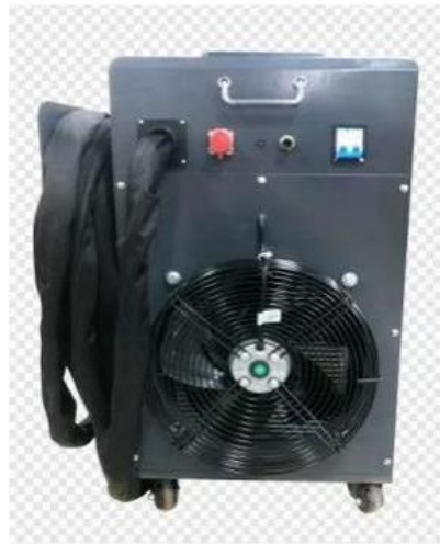
ด้านหลังของตู้ควบคุมแบบรวม (Back side of the integrated control cabinet)
